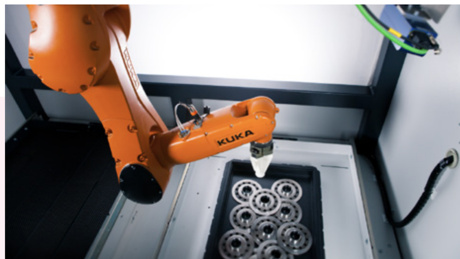
Figuur 31: gerobotiseerde bin-pickingmanipulator om verschillende objecten met diverse vormen te grijpen van Kuka
