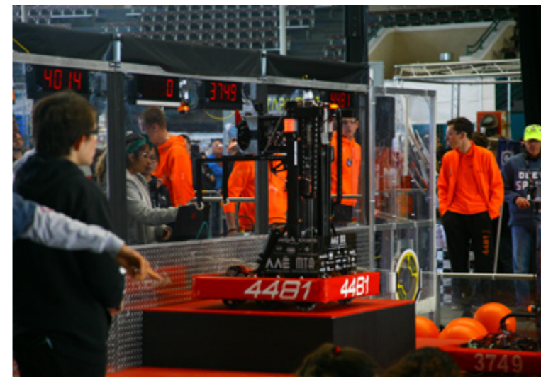
Figuur 27: educatieve mobiele robot, ontworpen aan Fontys Hogescholen om diverse objecten over een parcours te vervoeren tijdens de RoboCup-competitie
