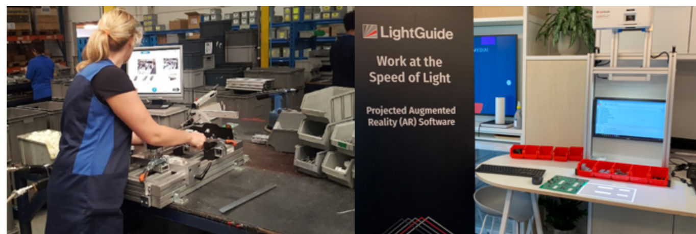
Figuur 22: voorbeelden van digitale werkinstructies. Links via een scherm, rechts via beeldprojectie
